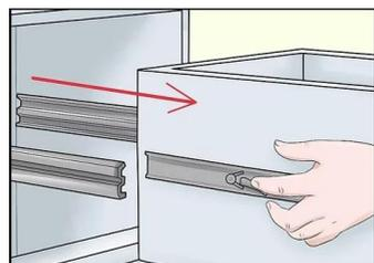
Generar presión en las palancas en sentidos contrarios y luego halar hacia afuera para desmontar cada cajón.
